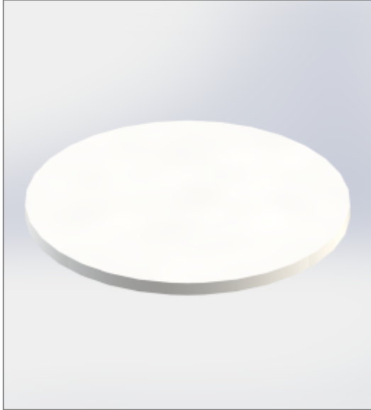
Образец №1 Ø35 мм, толщина = 1,5
