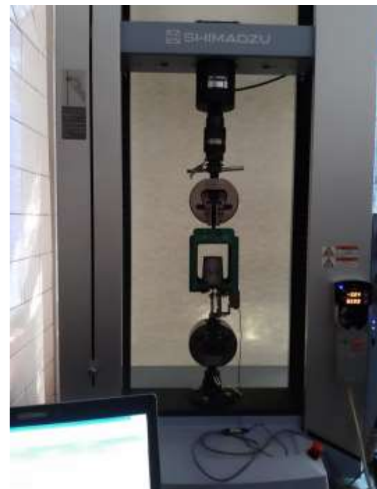
Рисунок 2. Испытательное оборудование (Shimadzu AGS-X 10 кН).
