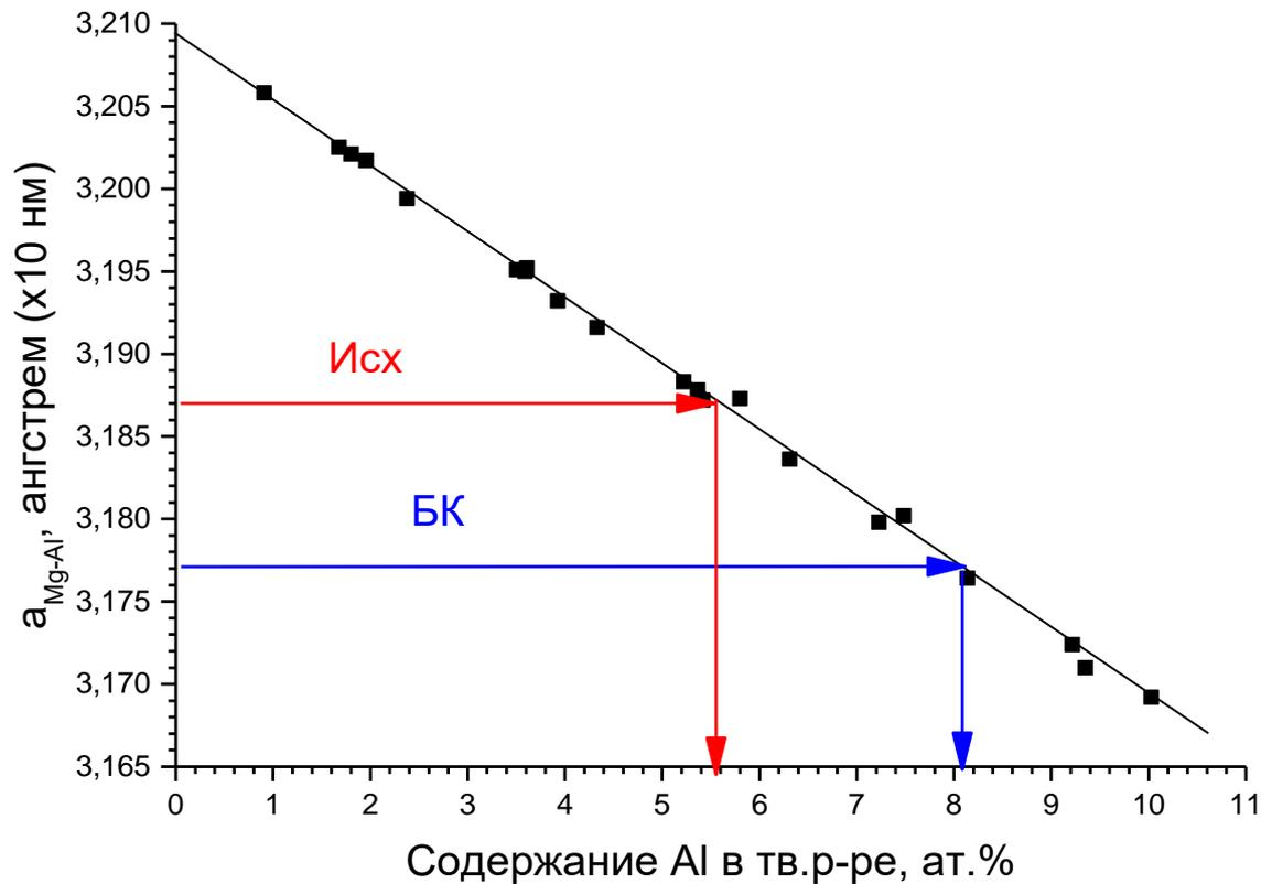
Зависимость содержания раствора количества  $\beta$ - фазы ( $Mg_{17}Al_{12}$ ) в сплаве МА5 ( $Mg-8,5Al-0,5Zn$ ) от параметра решетки твердого раствора
