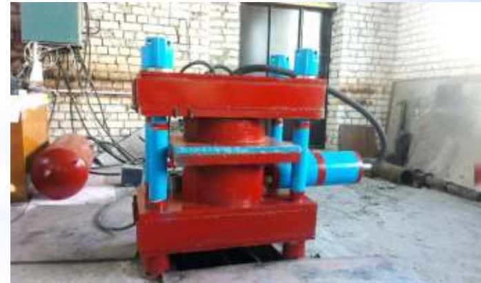
Устройство газовой формовки с противодавлением
