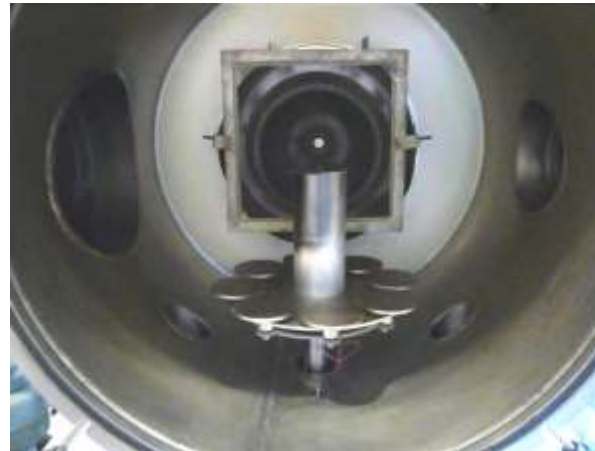
Рабочая камера имплантера (вид изнутри)
