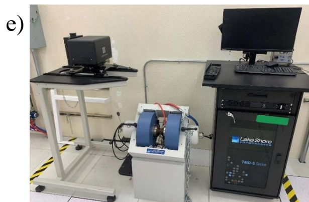
Рис.4 Общий вид экспериментальных установок, где: а) дилатометр Netzsch DIL 402С; б) дифрактометр ARL X'TRA; в) СЭМ Hitachi TM-3000; г) термоанализатор Netzsch STA 449С; д) установка для измерений температурных зависимостей тока электрической проводимости; е) вибрационный магнитометр VSM Lakeshore 7400 System
