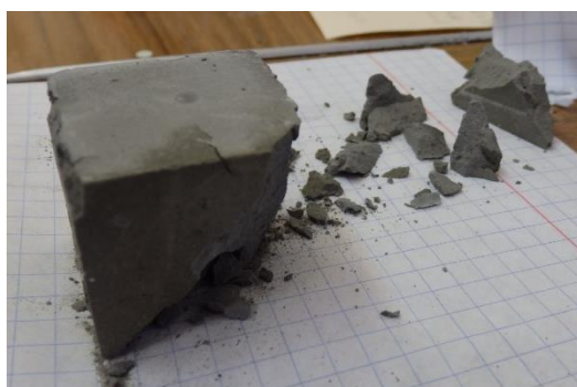
Рис. 4. Растрескивание и раскалывание образца цементного камня Р-1 во время испытаний ударно-импульсным методом
