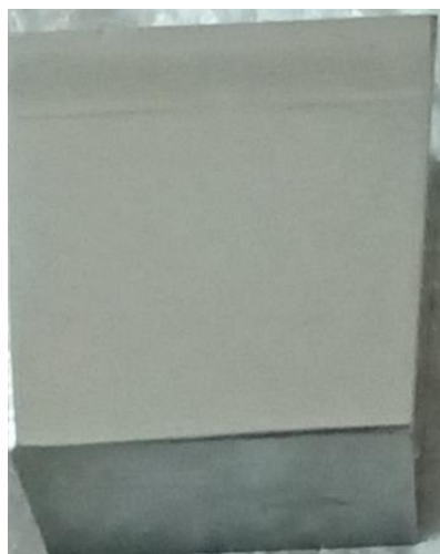
Рисунок 4. Поверхность образца из конструкционной легированной стали 4X5МФС после диффузионного оксидирования и полирования
