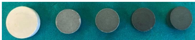
Рис. 1. Внешний вид опытных образцов: слева направо – из порошкового материала ПЭЭК; ПЭЭК + 10 масс. % \text{Mo}_2\text{B}_5 ; ПЭЭК + 20 масс. % \text{Mo}_2\text{B}_5 ; ПЭЭК + 30 масс. % \text{Mo}_2\text{B}_5 ; ПЭЭК + 40 масс. % \text{Mo}_2\text{B}_5
