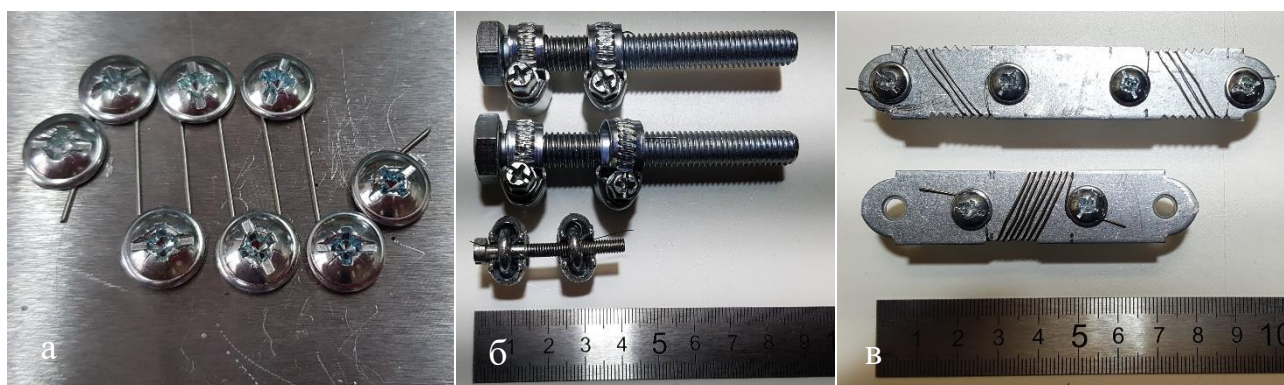
Рисунок 1. Оснастка для отжига образцов: а – образец синусоидальной формы, б – витой образец круглого профиля, в – витой образец прямоугольного профиля
