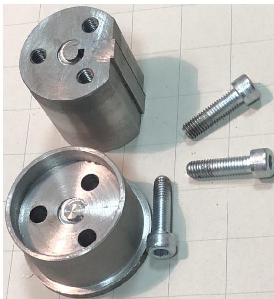
Рис. 2. Вид устройства в разобранном виде для РКУП призматической металлической заготовки с получением шайбы Гровера.
