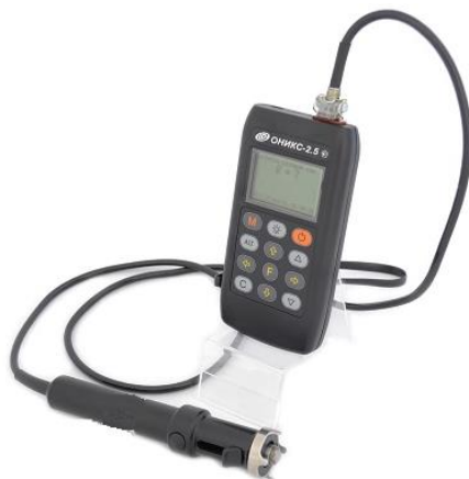
Рис. 1. Прибор неразрушающего контроля ударно-импульсный ОНИКС-2,5
