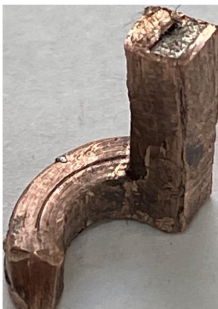
Рис. 3. Призматическая заготовка из меди, извлеченная из разборной матрицы устройства.
