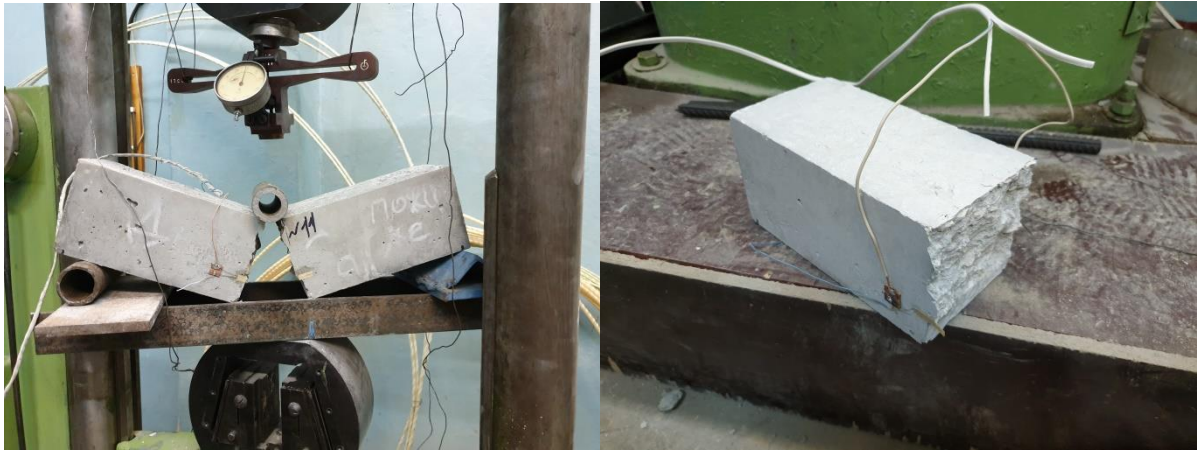
Рис. 4. Разрушение контрольного образца карбонатного бетона и его половина после разрушения с шероховатой развитой поверхностью
